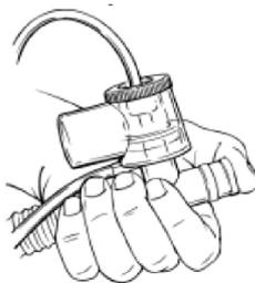
Рис. Е-1. Блокирование открытого конца контура пациента в однопатрубочном контуре
