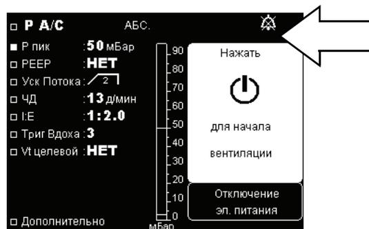
Рис. 3-4. Заглушение звуковой составляющей сигнализации
